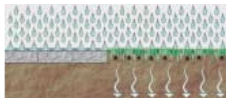
pénétration des eaux de pluie dans le sol
